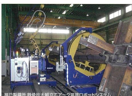
神戸製鋼所 鉄骨柱大組立てアーク溶接ロボットシステム
